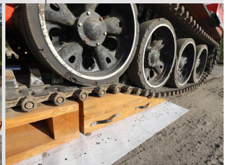
Détail d'accès d'un engin à chenilles sur la rampe en bois
