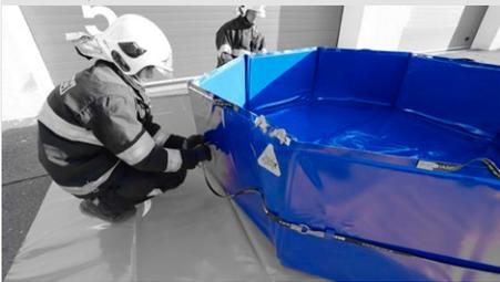
Voile hexagonale est après pliage assuré par crochets spéciaux
